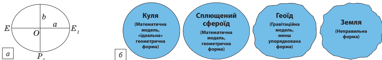
Мал. 1. а) Земний еліпсоїд; б) наближення до справжньої форми Землі.
