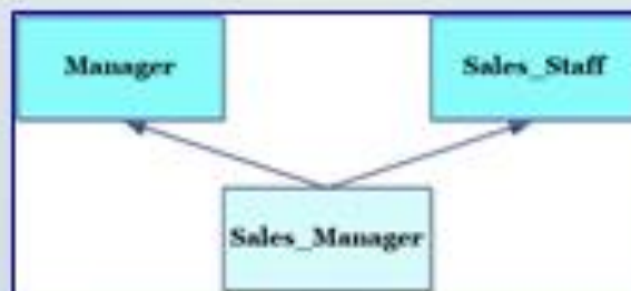
Рисунок 2 – Приклад множинного наслідування
