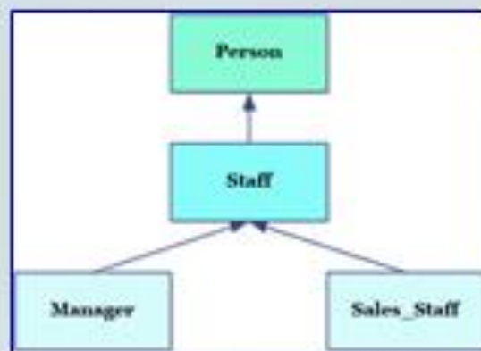
Рисунок 1 – Приклад одиничного наслідування
