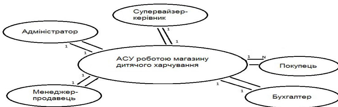
Рис. 1. Концептуальна модель автоматизованої системи управління роботою магазину дитячого харчування
