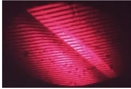
Рис.1. Интерференционная картина с введенной стеклянной пластиной для калибровки установки
