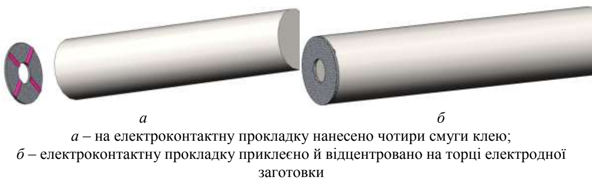
Рис. 18.5. Етапи монтажу електроконтактної прокладки \varnothing 220/\varnothing 630 мм товщиною 20 мм на торцевій поверхні електродної заготовки \varnothing 630 \times 2815 мм
