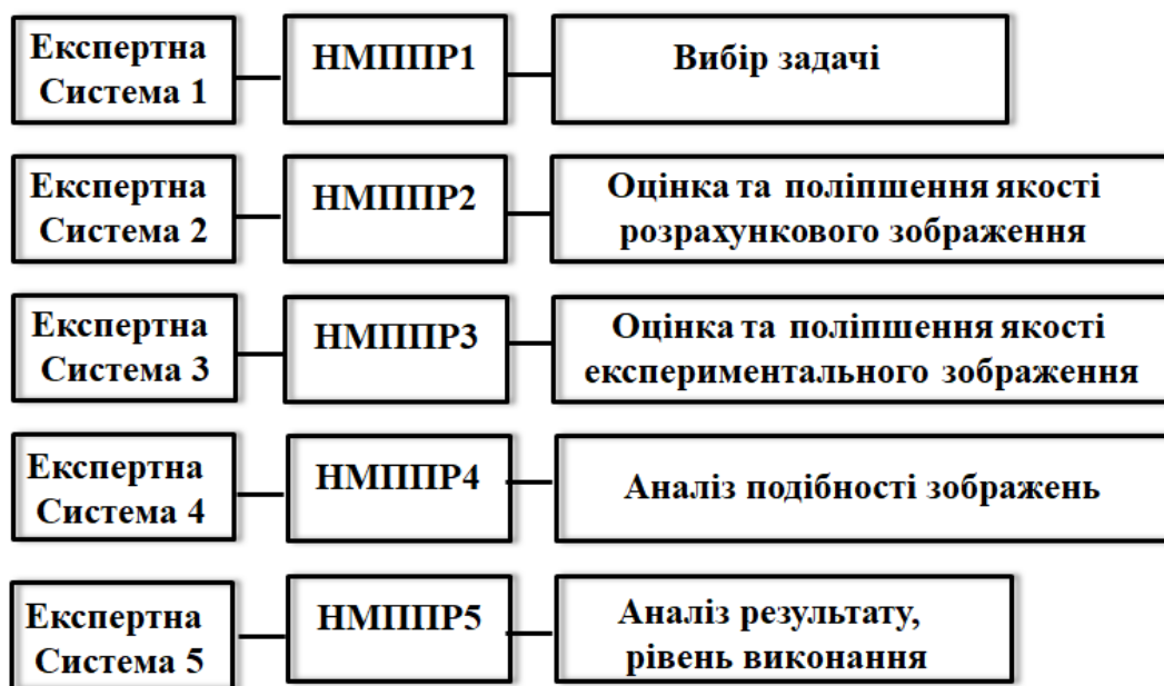
Рис. 3 Структура системи підтримки прийняття рішень в задачах оптичної метрології
