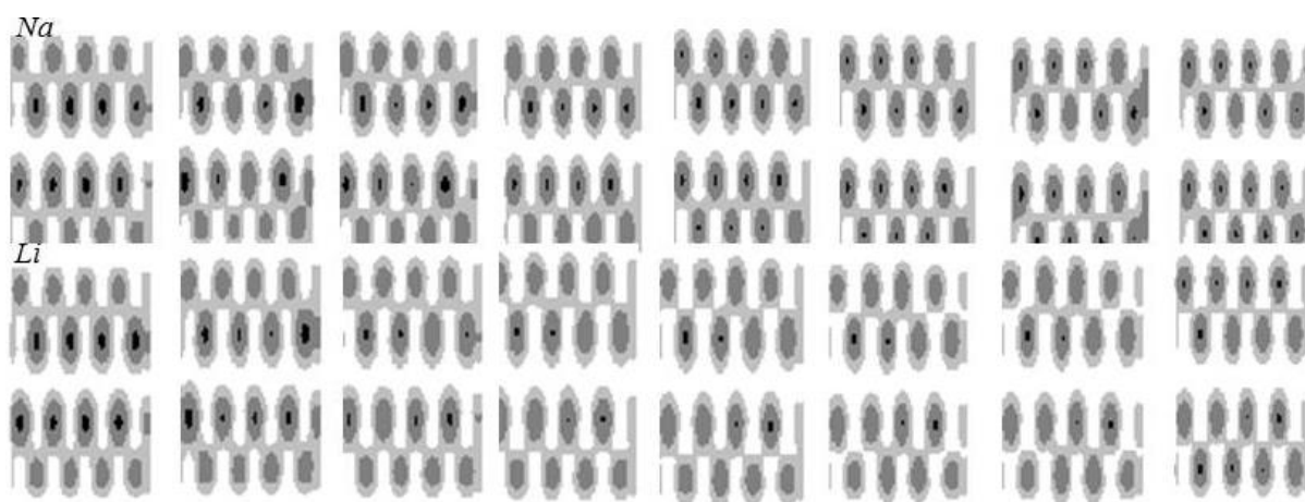
Рис. 1. Перерізи (110) просторових розподілів густини валентних електронів у межах комірки, атомний базис якої моделює два бішари \text{SnS}_2 , з інтеркальованими у міжшаровий прошарок \text{SnS}_2 атомами Na (верхній ряд) та Li (нижній ряд) при наповненості прошарку від 12,5% до 100%
