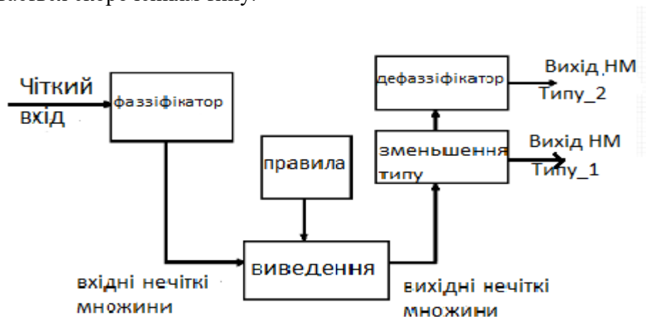
Рис. – 1 Схема обробки зображень з використанням нечітких множин типу_2
