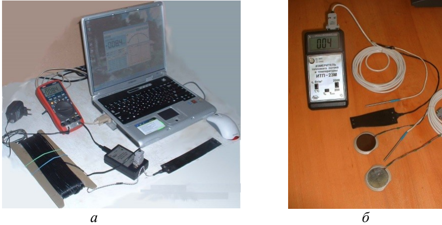
Рис. 5.13. Вимірювачі теплового потоку і температури моделей ИТП-22К (а), ИТП-23М (б) з комплектом сенсорів
