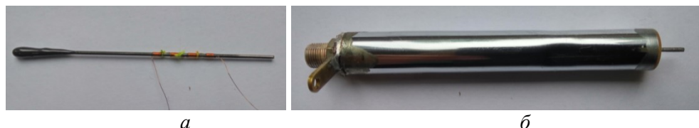
Рис. 4.27. Малоапертурні магнітострикційні сенсори: а – хвилевід з котушкою і демпфером, б – зовнішній вигляд
