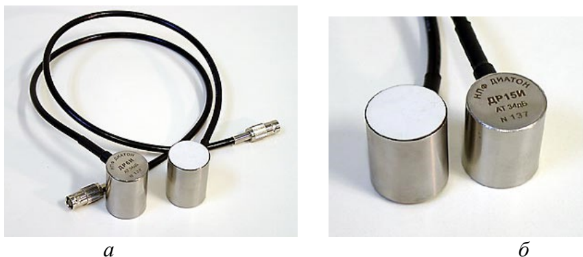
Рис. 4.17. ПАЕ виробництва ЗАТ «НПФ «Диатон»: а – ДР6И, б – ДР15И
