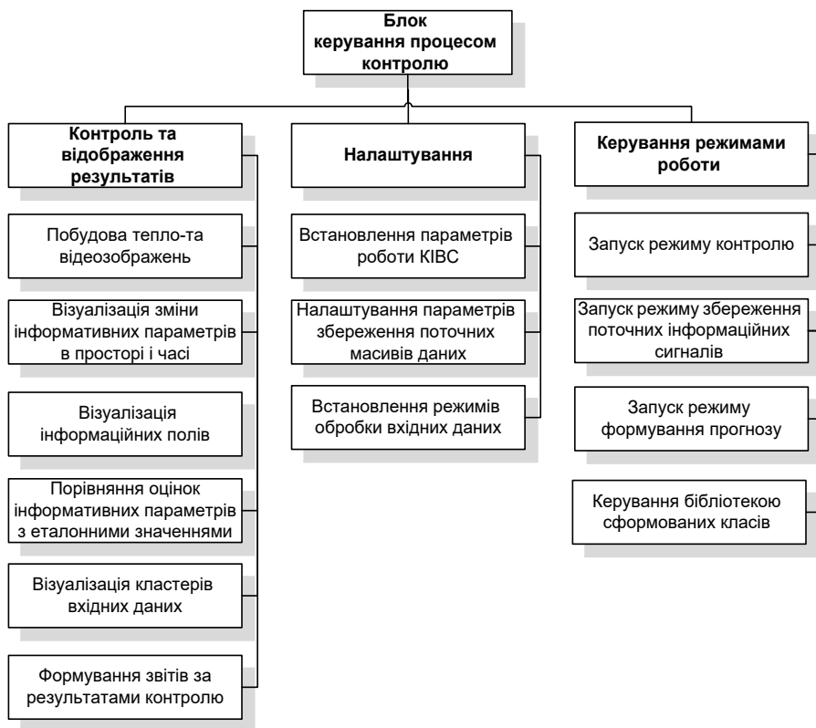
Рис. 4.40. Структура модуля керування процесом контролю
