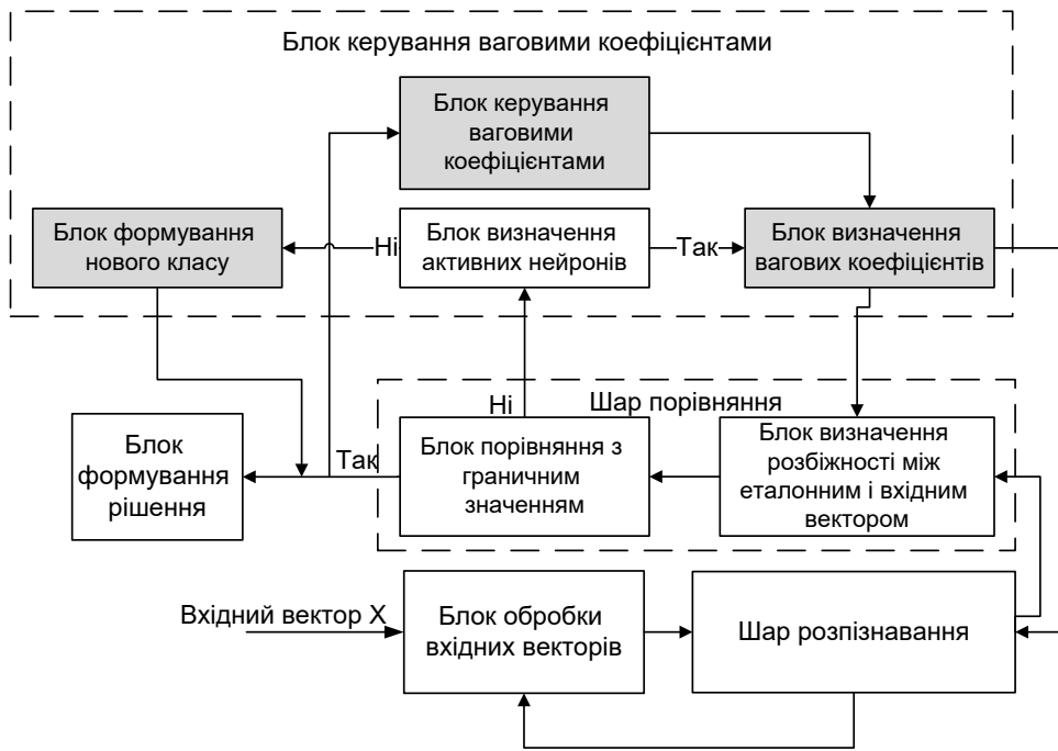
Рис. 4.41. Структурна схема класифікатора на основі нейронної мережі ART-2
