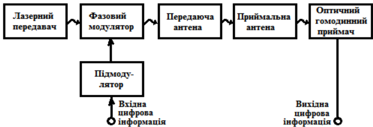
Рисунок 5.15 – Блок-схема лазерної системи зв'язку з кодово-імпульсною модуляцією за фазою й гомодинним приймачем
