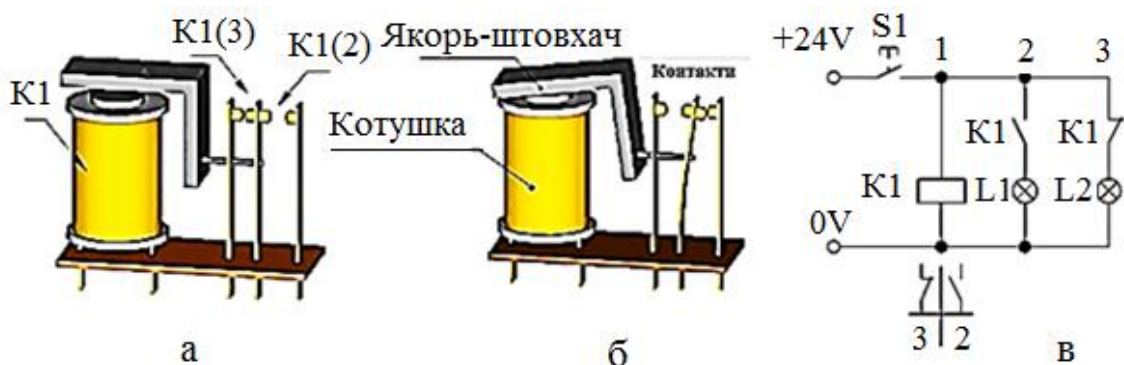
Рис. 1.26. Конструктивні схеми і електрична схема включення електромагнітного реле: а – стан реле, коли кнопка пуск S1 не натиснена, при цьому індикатори L1 та L2 відключені від джерела струму; б – стан реле, коли натиснута кнопка пуск S1, при цьому індикатор L1 включений, індикатор L2 – вимкнений.
