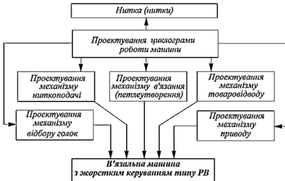
Рис. 3.3. Топологія традиційного конструктивного проектування в'язальних машин
