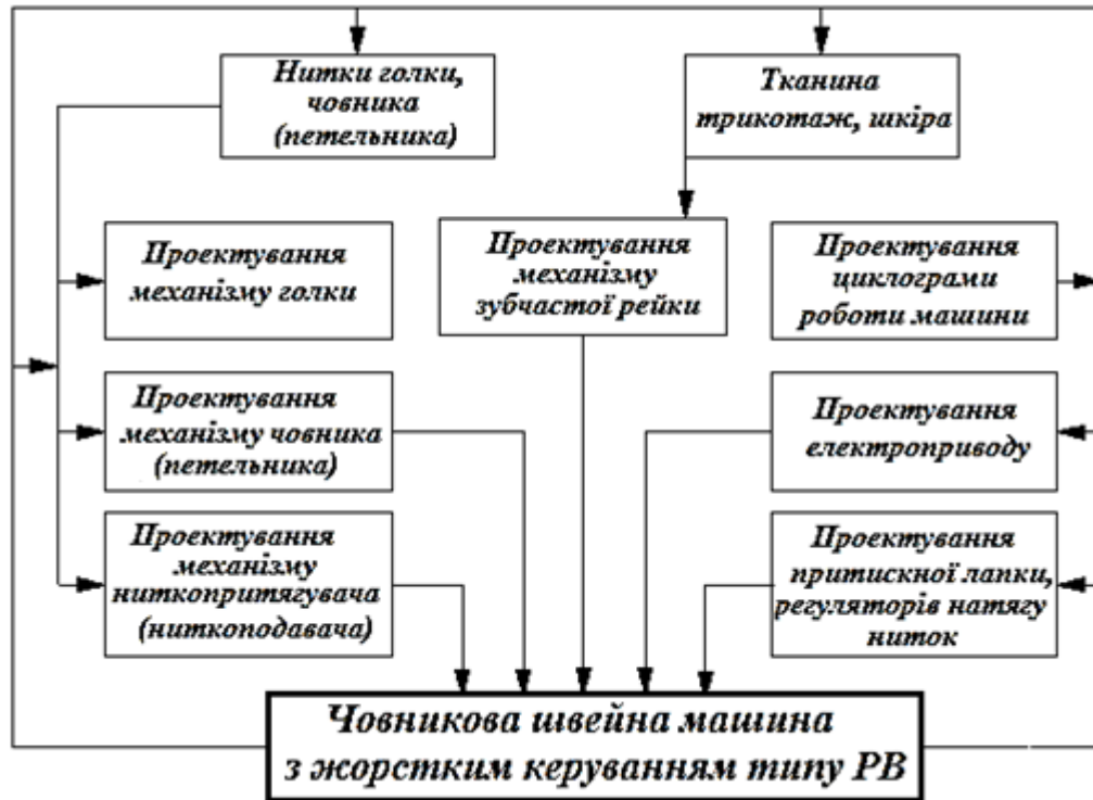
Рис. 3.1. Топологія традиційного конструктивного проектування неавтоматизованих швейних машин
