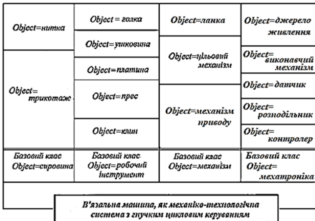
Рис. 3.3. Топологія традиційного конструктивного проектування в'язальних машин
