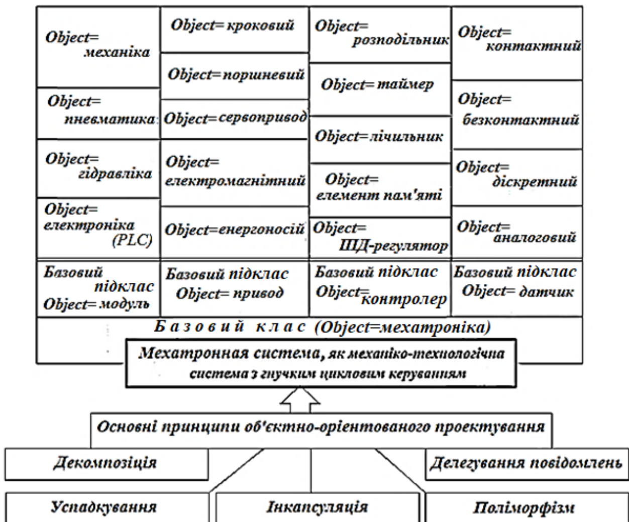
Рис. 3.6. Топологія об'єктно-орієнтованого конструктивно-технологічного проектування мехатронних систем
