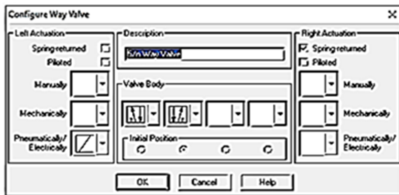
Рис. 8.2. Приклад меню діалогу (а) додавання конструктивних особливостей обраного пневмо-розподільника і результат (б) двох реалізованих опцій
