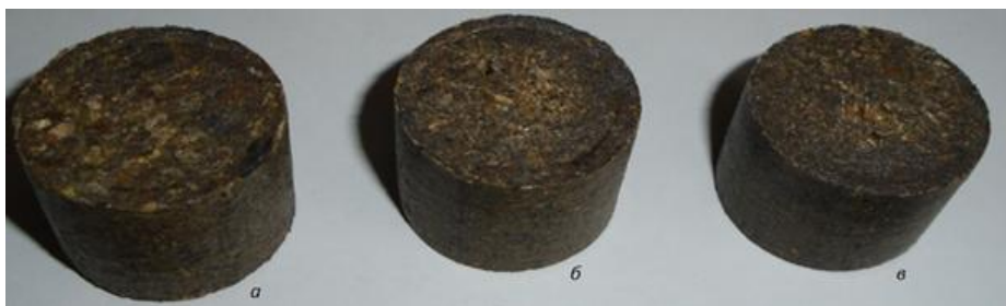
Рис. 10.12. Зразки пелет d = 27 мм, виготовлені з суміші соломи, тирси, листя дубу (1 : 1 : 1) та бурого вугілля а – 5 % вугілля, б – 10 % вугілля, в – 15 % вугілля
