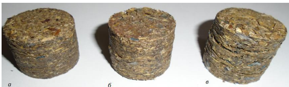
Рис. 10.11. Зразки пелет d = 27 мм, виготовлених з соломи та ПЕТ а – 10 % ПЕТ, б – 20 % ПЕТ, в – 30 % ПЕТ
