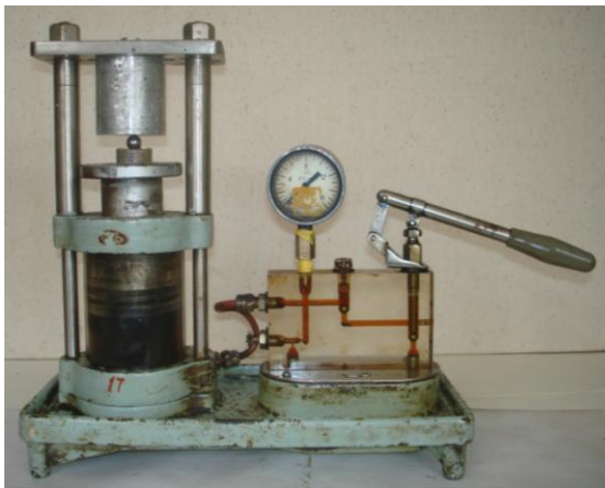
Рис. 10.8. Лабораторний прес для дослідження зразків біопалива на твердість
