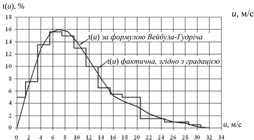
Рис. 5.1. Розподіл повторюваності швидкості вітру
