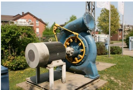
Рис. 4.7. Вигляд радіально-осьової турбіни (турбіни Френсіса) з генератором
