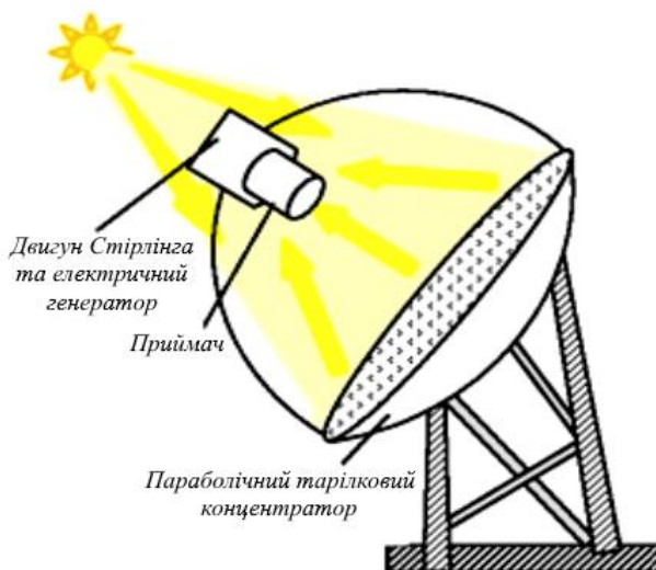
Рис. 3.7. Сонячна теплова електростанція тарілкового типу
