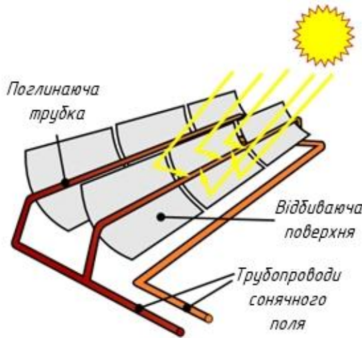
Рис. 3.6. Сонячна теплова електростанція параболічного типу
