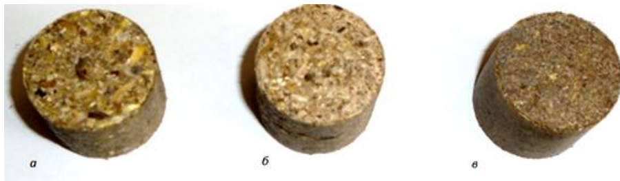
Рис. 10.9. Зразки пелет (діаметр 27 мм, довжина 30 мм) виготовлених при тиску 263,2 МПа
