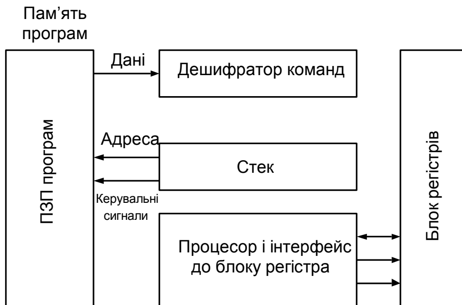
Рисунок 1.5 Структура комп'ютера із Гарвардською архітектурою
