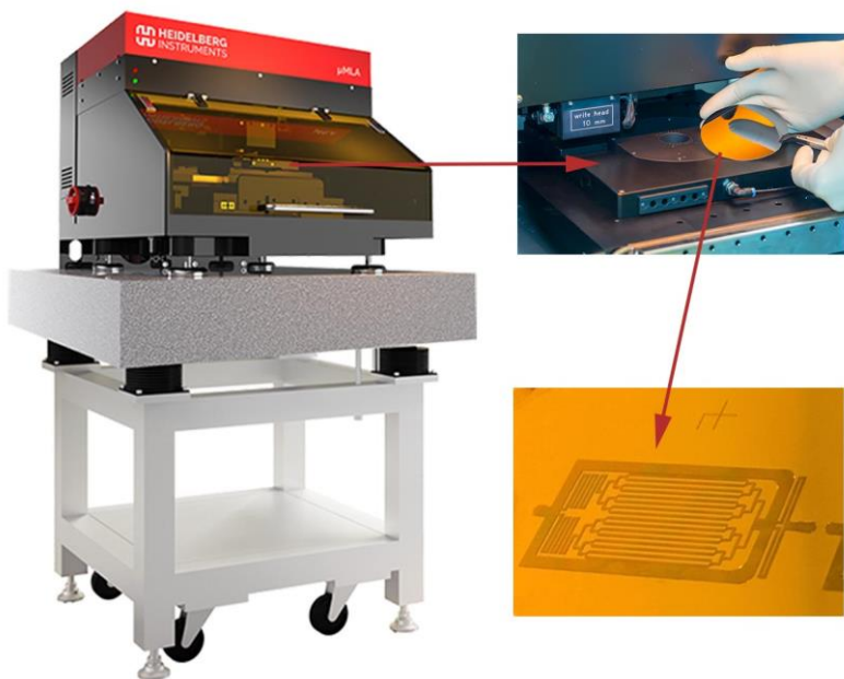
Рисунок 3.4 – Обладнання для проведення безмаскової фотолітографії
