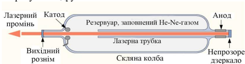
Рисунок 2.5 – Конструкція He-Ne-лазера
