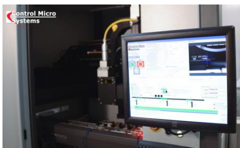
Рисунок 3.12 – Лазерне маркування друкованих плат: установка компанії CMS (Control Micro Systems) Laser ( a ), вікно програми для контролю за процесом маркування ( б ) та зовнішній вигляд готової продукції ( в )
