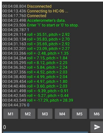
Рисунок 4.99 – Отримання даних обертання навколо осі X та осі Y від акселерометра
