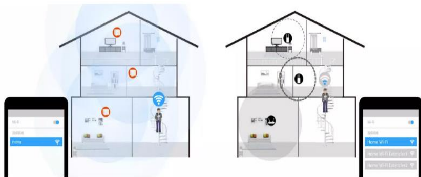
Рисунок 2.4 – З'єднання Mesh системи та звичайної Wi-Fi мережі [44]
