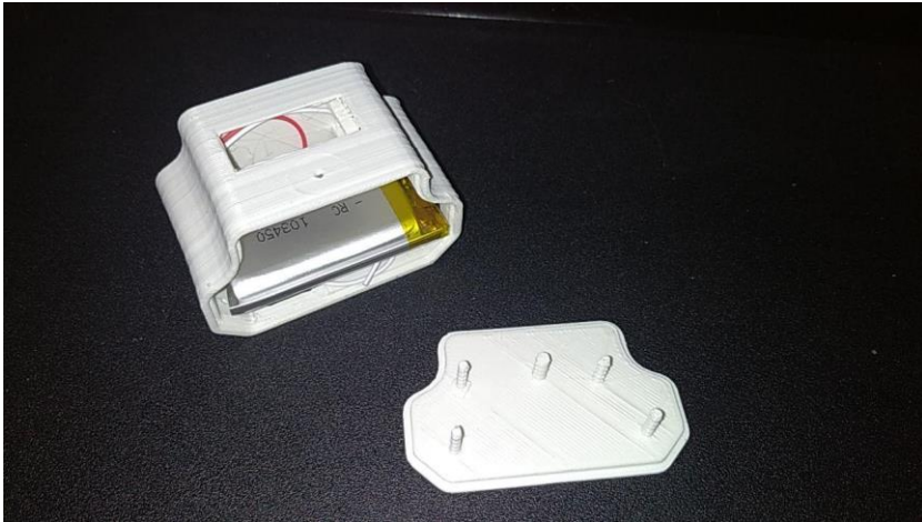
Рисунок 3.28 – Роздруковані частини фізичного прототипу проектованого браслету
