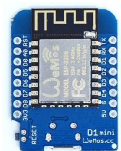
Рисунок 3.5 – Wi-Fi модуль WeMos D1 mini на чіпі ESP8266 [49]
