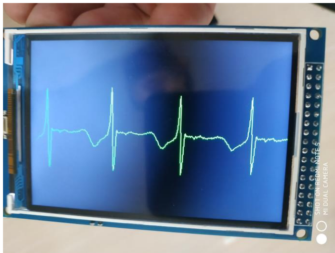
Рисунок 4.11 – Приклад виведення ЕКГ на TFT дисплей
