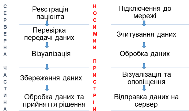
Рисунок 3.2 – Функціональна схема системи віддаленого моніторингу
