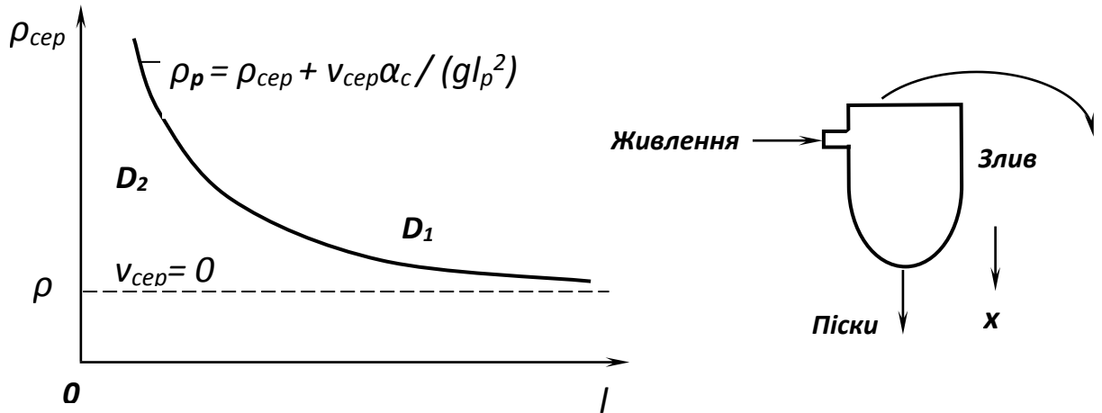
Рисунок 5.12 – Границя розділення апарата з висхідним потоком.
