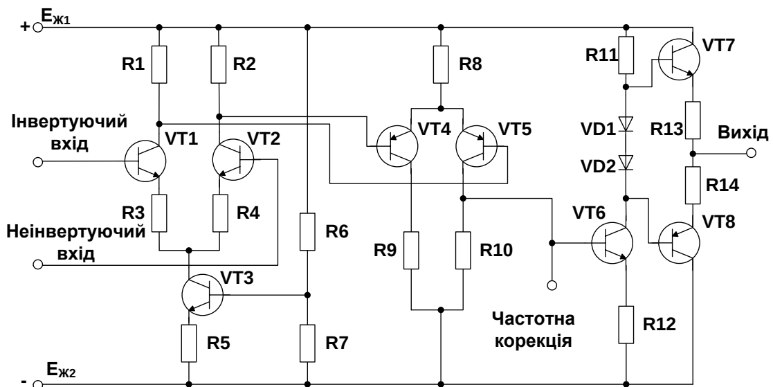
Рис. 2.41. Спрощена принципова схема ІМС ОП
