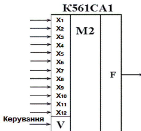
Рис. 12.25. Позначення на електричних схемах ІМС К561СА1
