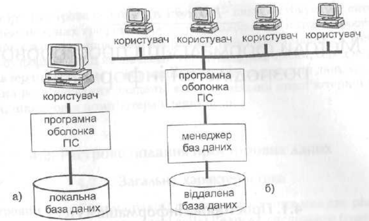
Рис. 3.5. Схеми організації роботи з базами даних при різних варіантах архітектури ГІС: а) локальна база даних; б) віддалена база даних
