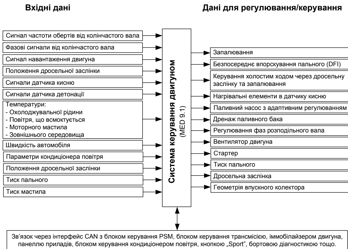
Рисунок 3.8 – Схема інформаційних потоків системи керування двигуном MED 9.1
