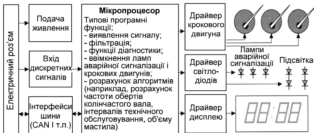
Рисунок 8.4 – Блок-схема функціонування комбінації приладів з використанням бортового контролера зв'язку CAN
