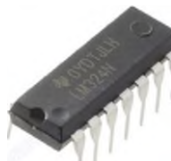
Рис. 9.21. Схема операційного підсилювача та мікросхема LM324:
