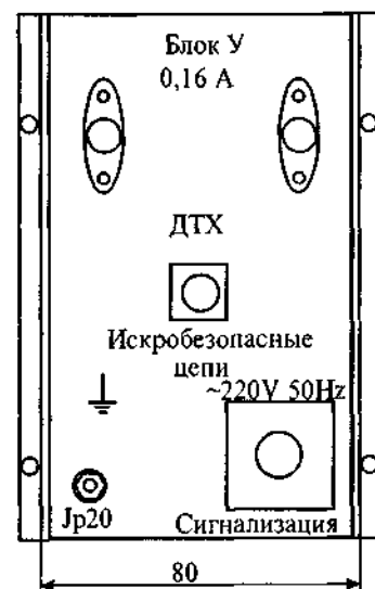
Рис.6.13. Загальний вигляд і габаритні розміри блоку У-1 (довжина 315 мм).
