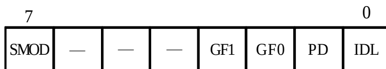
Рисунок 13. Формат регістра спеціальних функцій PCON
