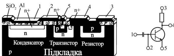
Рисунок 2.35 – Структура й електрична схема планарно-дифузійної НІМС: 1–5 – точки підключення до електричного ланцюга
