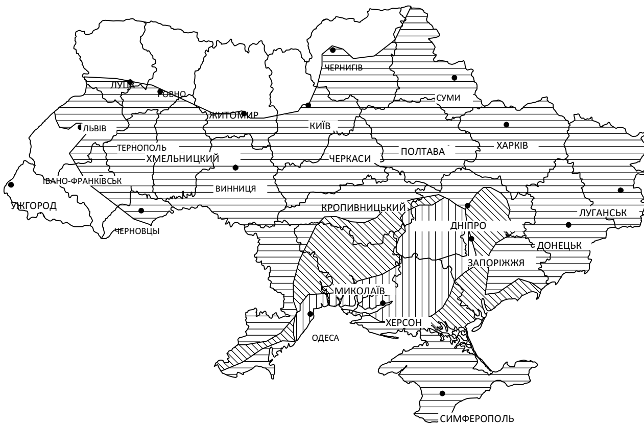
Рисунок 1.1 – Схема розповсюдження лесових ґрунтів (за Чорним Г. І.)
