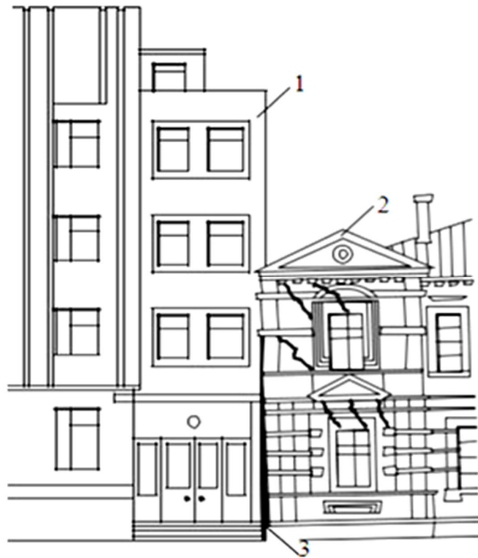
Рисунок 11.1 – Вплив нового будинку на існуючу забудову: 1 – новий будинок; 2 – дореволюційний будинок із нахилом у бік нового; 3 – щілина між будинками
