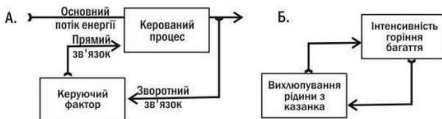
Рис. 15. Пояснення поняття зворотного зв'язку. А. Прямий і зворотний зв'язок. Б. Приклад зворотного зв'язку
