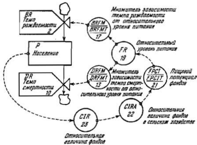
Рис. 30. Сектор забезпеченістю їжею. Петлі негативного зворотного зв'язку, що встановлюють чисельність населення на максимальному рівні, який може забезпечити виробництво продуктів харчування.
