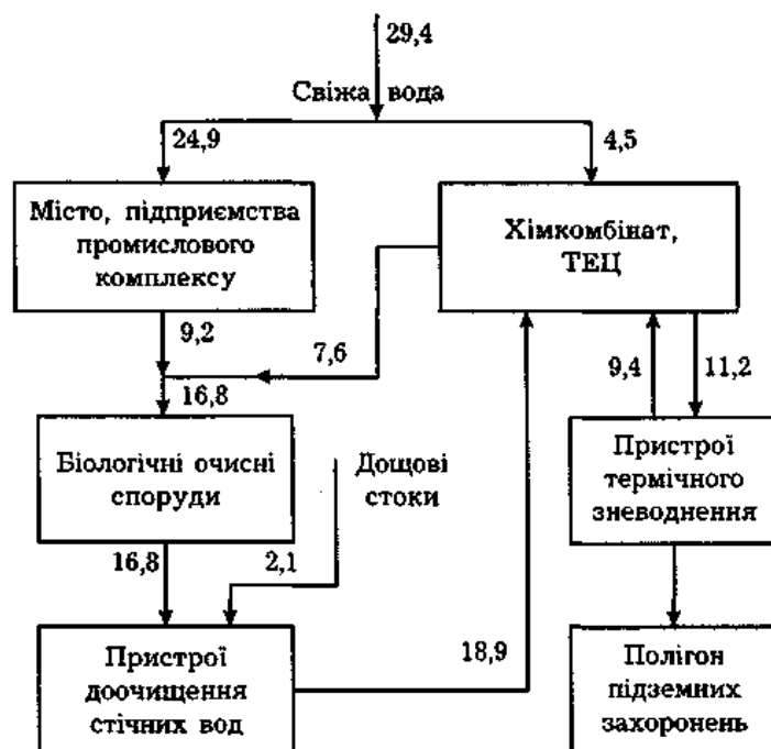
Рис. 13.4 – Комплексна схема і баланс споживання води з використанням стічних вод хімічного комбінату, ТЕЦ, міста та підприємств промислового комплексу (цифри – витрата води в тис. \text{м}^3/\text{добу} з вирахуванням безповоротних втрат)
