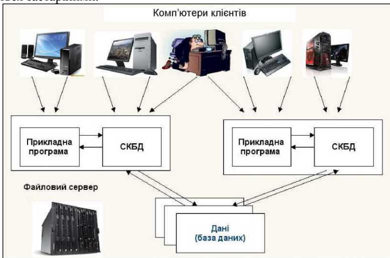
Рис. 2.11. Схема обробки інформації в БД за архітектурою "файл - сервер"
