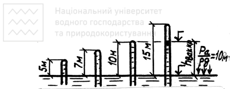
Рис. 4.2. Схеми заповнення водою закритих пезометрів
