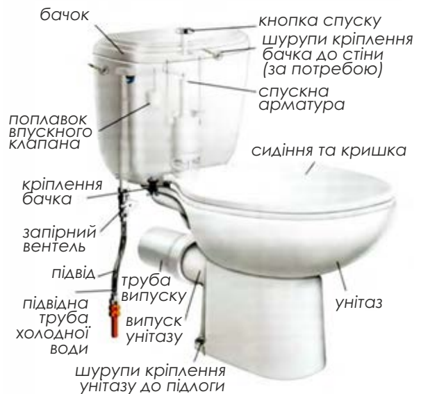
Рис. 42 - Конструкція унітазу
