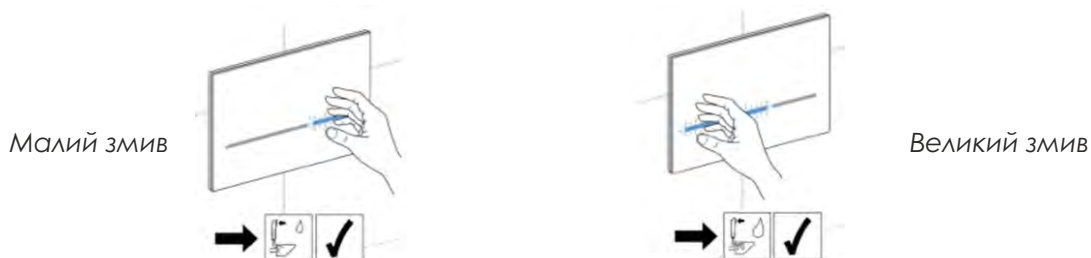
Рис. 49 - Функція подвійного змивання в безконтактній клавіші
