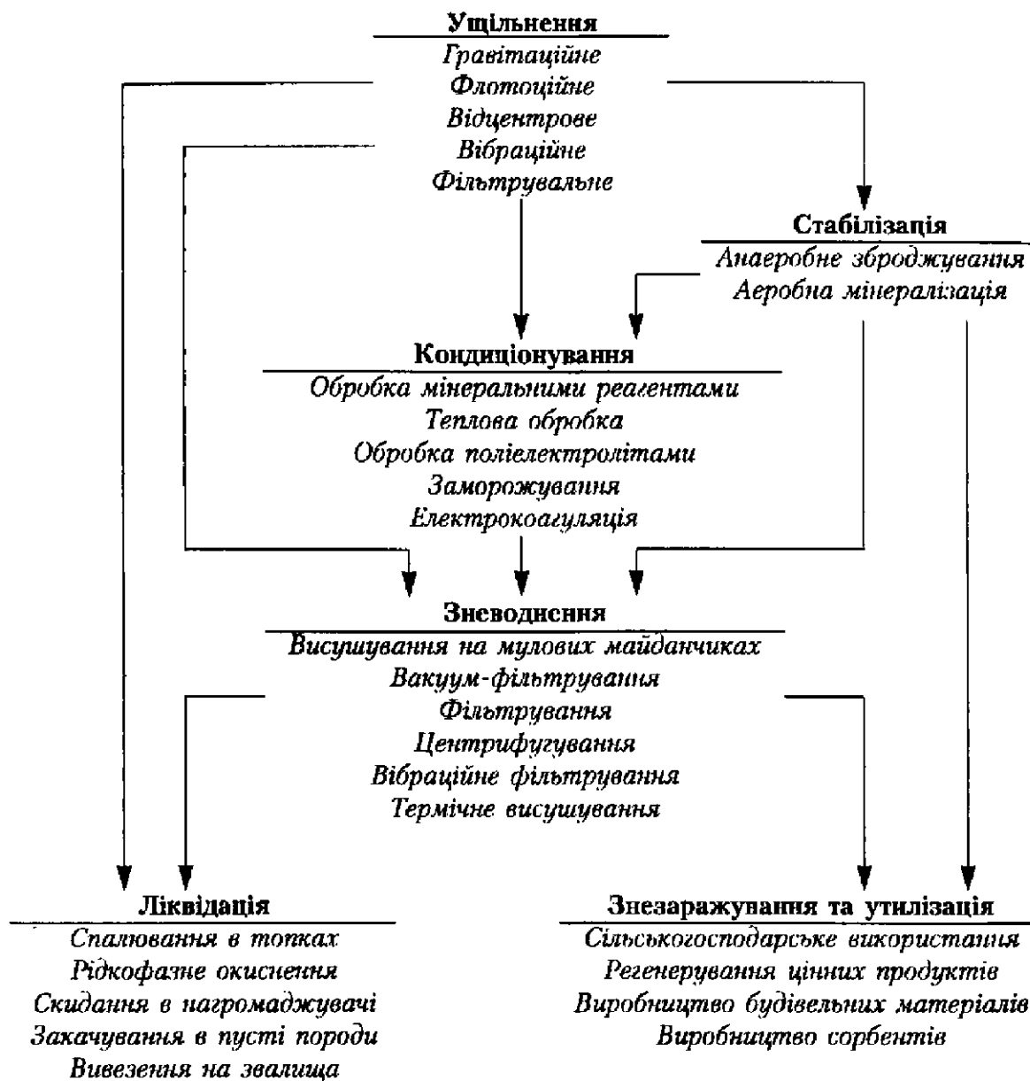
Рисунок 8.3 - Типові процеси обробки осадів стічних вод
