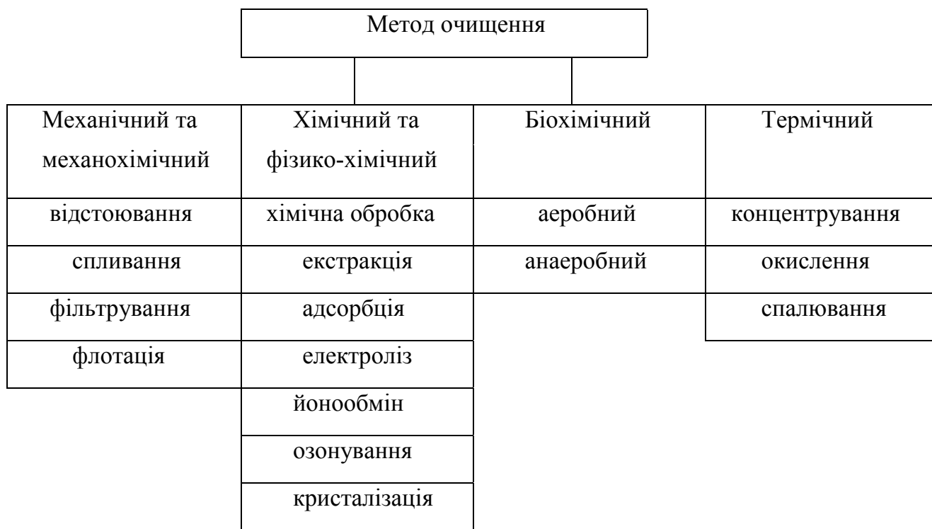
Рисунок 7.2- Класифікація методів очищення промислових стічних вод
