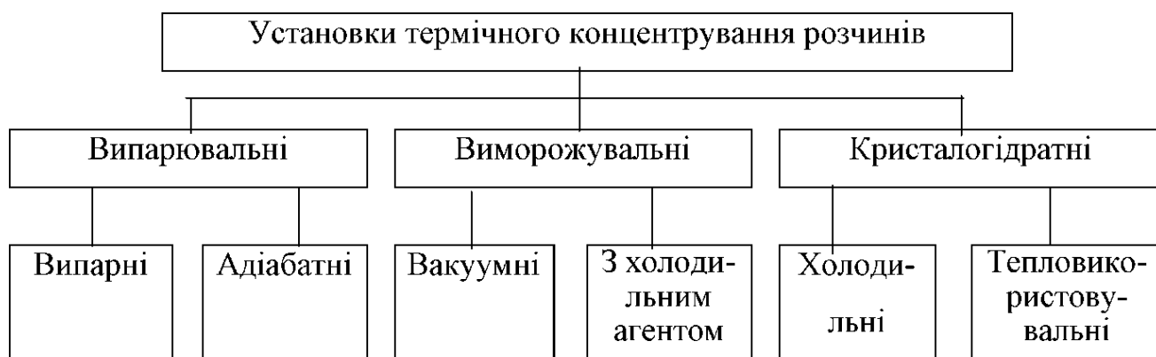
Рисунок 7.24 - Класифікація установок термічного концентрування СВ
