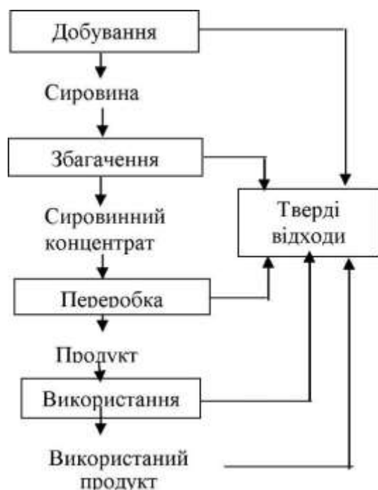
Рисунок 10.1 - Джерела виникнення твердих відходів у матеріальному виробництві.
