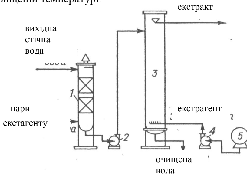
Рисунок 9.1 – Схема екстракційної установки для очистки стічних вод від фенолів:
