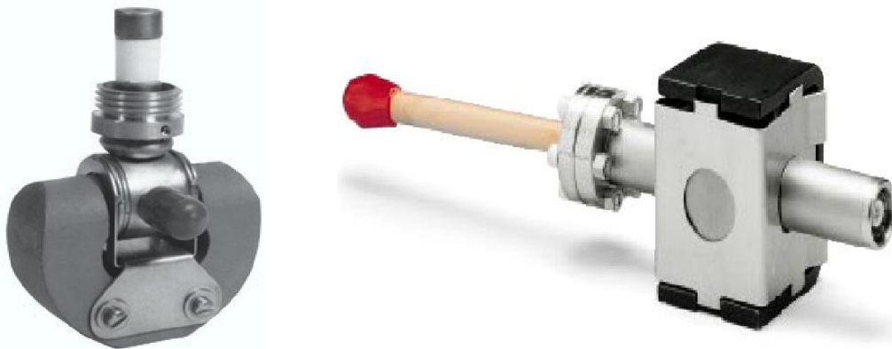
Рис. 4.66. Магніторозрядні насоси: справа - Thermionics AIP-0,2T (розміри 94×64×35 мм); S_n=0,2\text{ л/с} ; P_{\text{гр}}=10^{-9}\text{ Па} . Зліва - Varian Vaculon Mini (розміри 63×54×54 мм); S_n=0,4\text{ л/с} ; P_{\text{гр}}=10^{-5}\text{ Па} .
