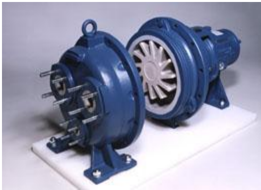
Рис.2.11. Рідинно-кільцевий насос: 1-статор; 2-ротор; 3-вода, яка утримується відцентровою силою.
