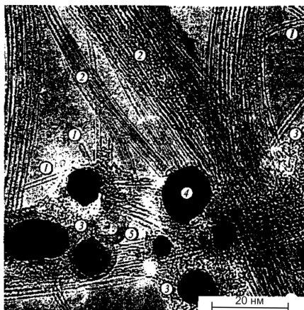
Рис. 2.29. Суміш продуктів синтезу вуглецевих наноструктур, отриманих при електродуговому синтезі: 1 – ізольовані одностінні трубки; 2 – джуги одностінних трубок; 3 – аморфний вуглець; 4 – частинки каталізатору; 5 – цибулини
