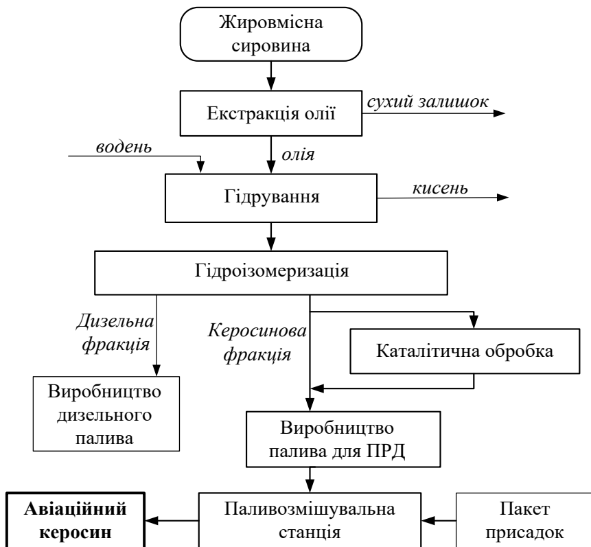
Рис. 3.8. Схема виробництва авіаційного палива з жировмісної сировини
