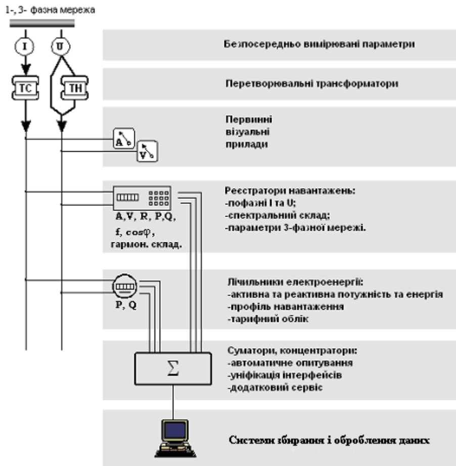
Рис. 11.2. Схема вимірювання параметрів електричної енергії
