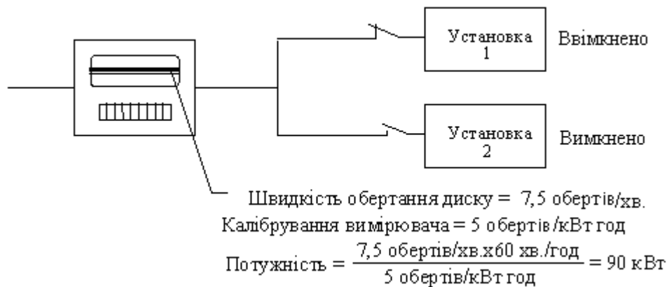
Рис. 3.4. Схема перевірного тесту
