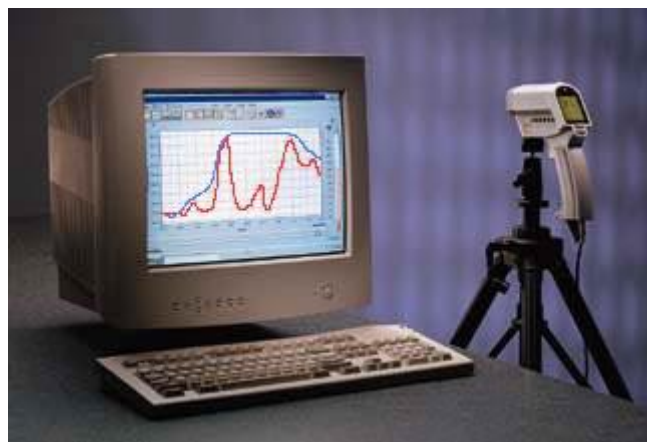
Рис. 11.21. Взаємодія Raynger MX4 з персональним комп'ютером
