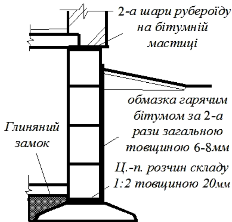
Рис. 8.19. Капілярна гідроізоляція фундаменту
