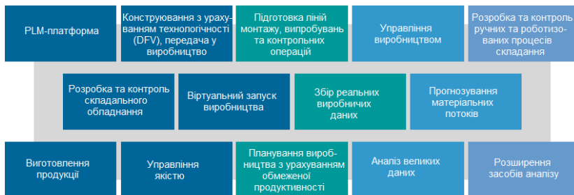
Рис. 1.9. Структура розумного виробництва компанії Mentor
