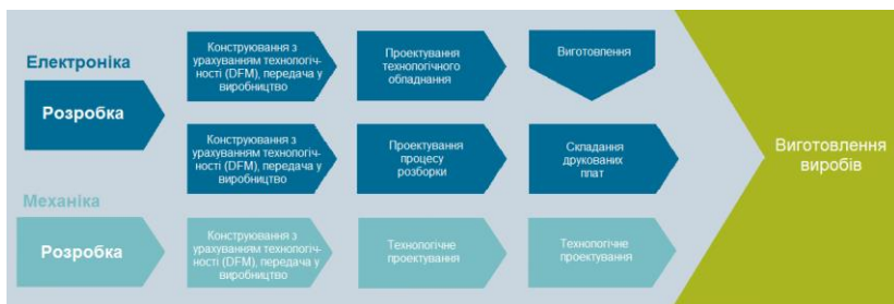
Рис. 1.10. Функціональна основа розумного виробництва в електронній промисловості
