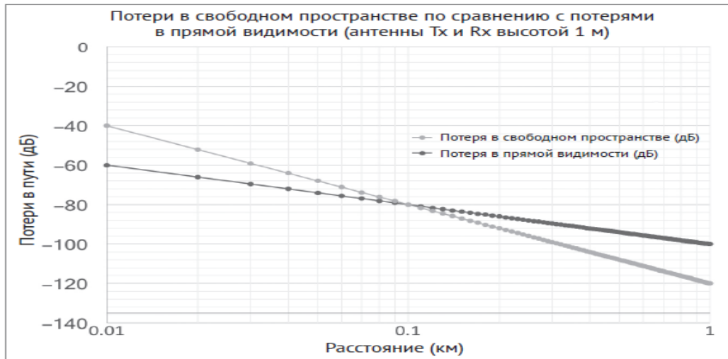
Рисунок 4.2 Втрати у вільному просторі в порівнянні з плоскою землею (в дБ) з використанням сигналу 2,4 ГГц з антенами висотою 1 метр
