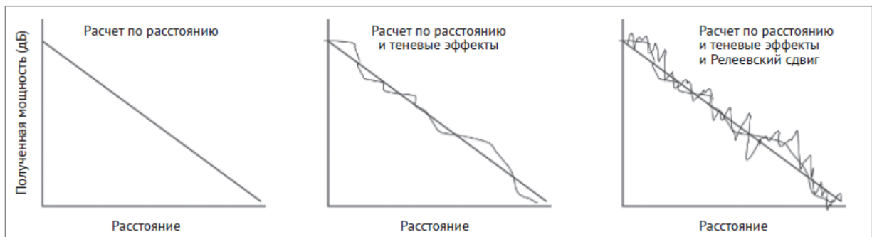
Рисунок 4.6 Різні ефекти завмирання радіочастотного сигналу. Зліва направо: загальні втрати на шляху прямої видимості. Середній: ефекти повільного завмирання через наявність великих структур або ландшафту. Справа: комбіновані ефекти відстані, повільного і швидкого
