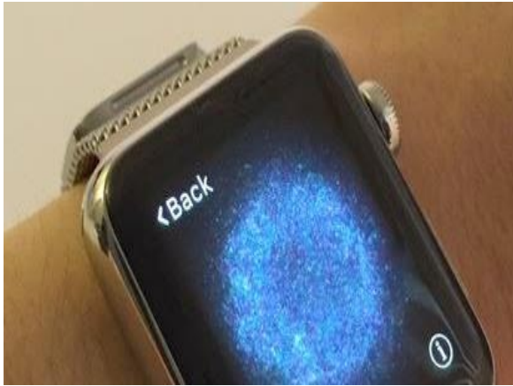
Рисунок 5.7 ООВ - Apple Watch при паруванні показує хмару точок, яку потрібно відсканувати камерою iPhone
