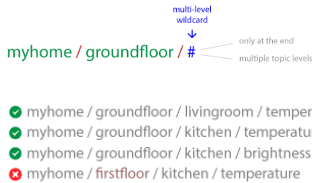
Рисунок 9.20 Приклад підписки з шаблоном myhome/groundfloor/#
