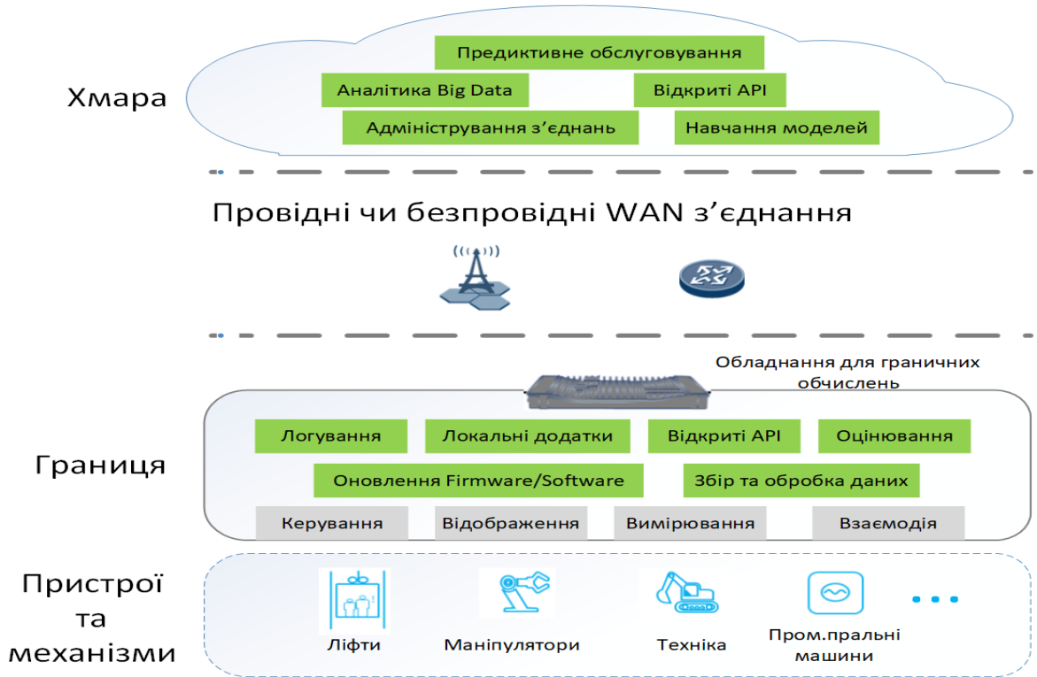
Рисунок 10.12 Схема логічної архітектури граничних обчислень
