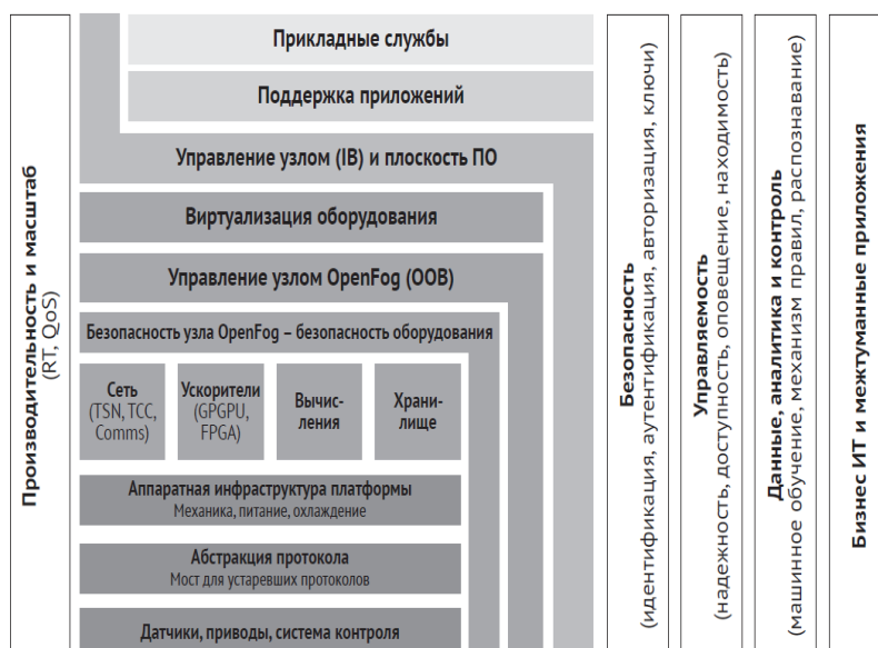
Рисунок 10.14 Архітектура OpenFog RA
