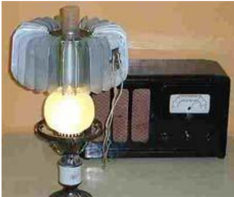
Рисунок 3.13 Термоелектричний генератор ТКГ-3
