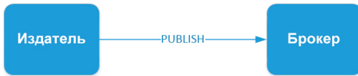
Рисунок 9.6 QoS-0. Незавірена передача
