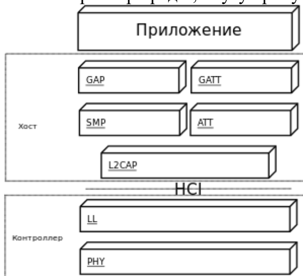
Рисунок 5.5 Стек протоколів BLE
