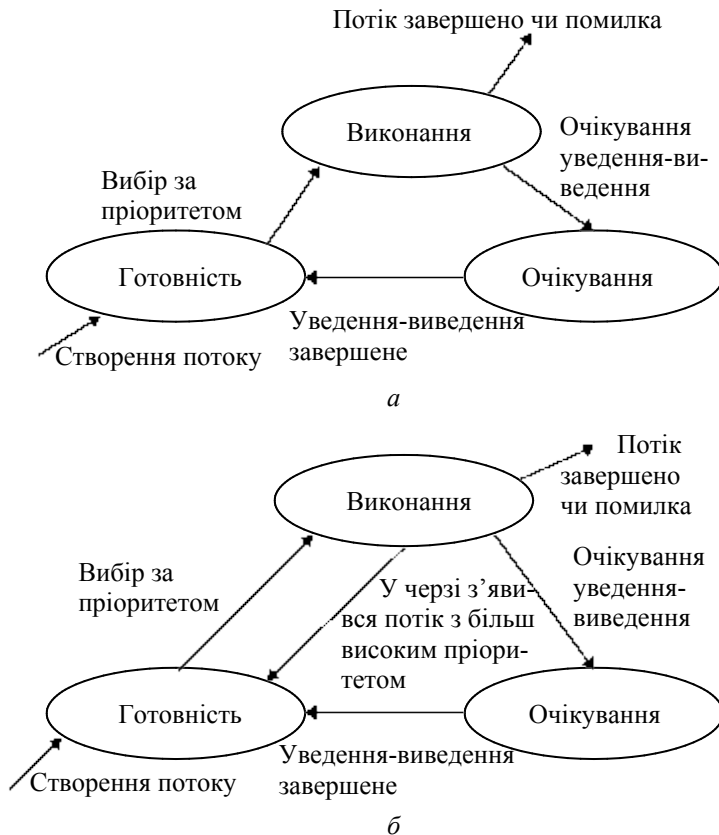
Рис. 2.8. Графи станів потоків у системах з відносними і абсолютними пріоритетами
