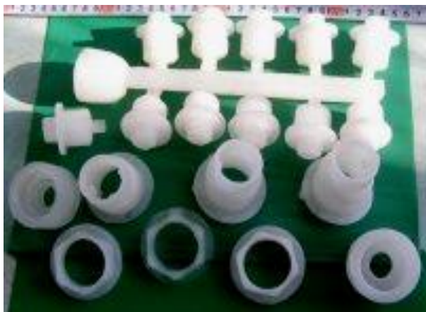
Рис.6.10. Зразки ливникової системи з крижаними моделями. Спостереження створення полікристалічної структури прозорої моделі, формування в сухому піску, видалення моделі, витягування з сухого наповнювача та сушка оболонки, фізико-хімічний підбором модельно-зв'язуючих композицій, процеси тепло- і масо-переносу і поверхневі явища охоплюють майже всі модельно-формувальні процеси (з низкою фазових переходів). Інноваційний характер нових кріовакуумних технологій, їх екологічність, енерго- і ресурсозбереження дають переваги застосування їх на виробництві.
