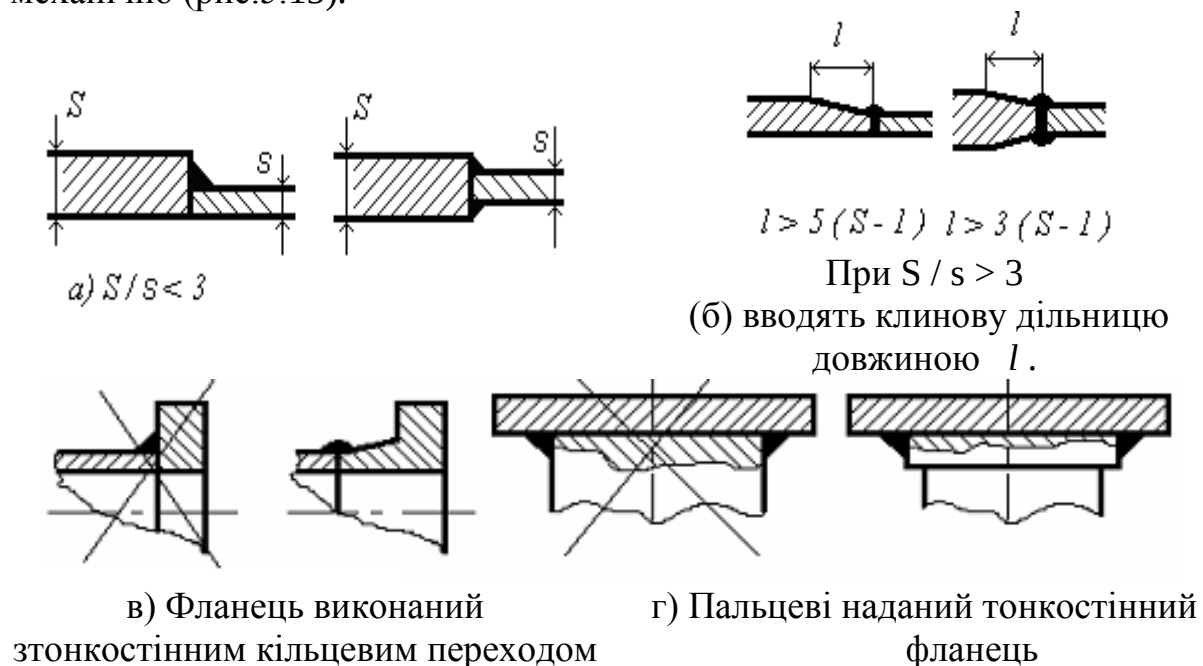
Рис. 5.12. Зварювання деталей різної товщини
