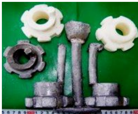
Рис. 6.9. Зразки крижаних моделей, та виливки з чорних металів за крижаними моделями.
