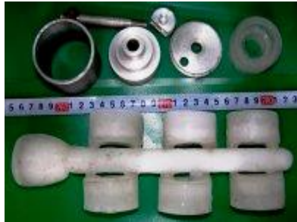
Рис. 6.8. Крижані моделі, виливки з чорних і кольорових металів за крижаними моделями.
