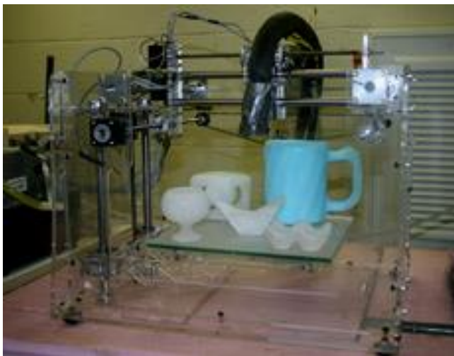
Рис. 6.11. Перший робот для створення „цифрових крижаних скульптур”
