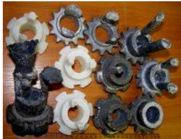
Рис. 6.6. Крижані моделі, та виливки з чорних і кольорових металів за крижаними моделями
