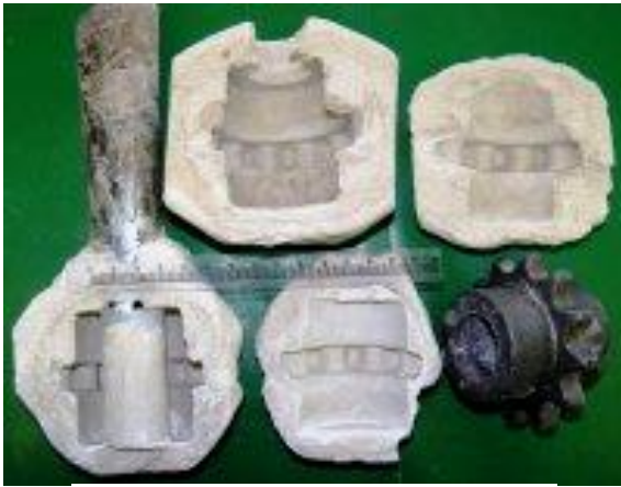
Рис. 6.5. Зразки крижаних моделей виливків, що отримуються при замороженні води
