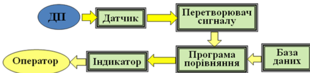
Рисунок 2.5 – Структурна схема діагностичної експертної системи
