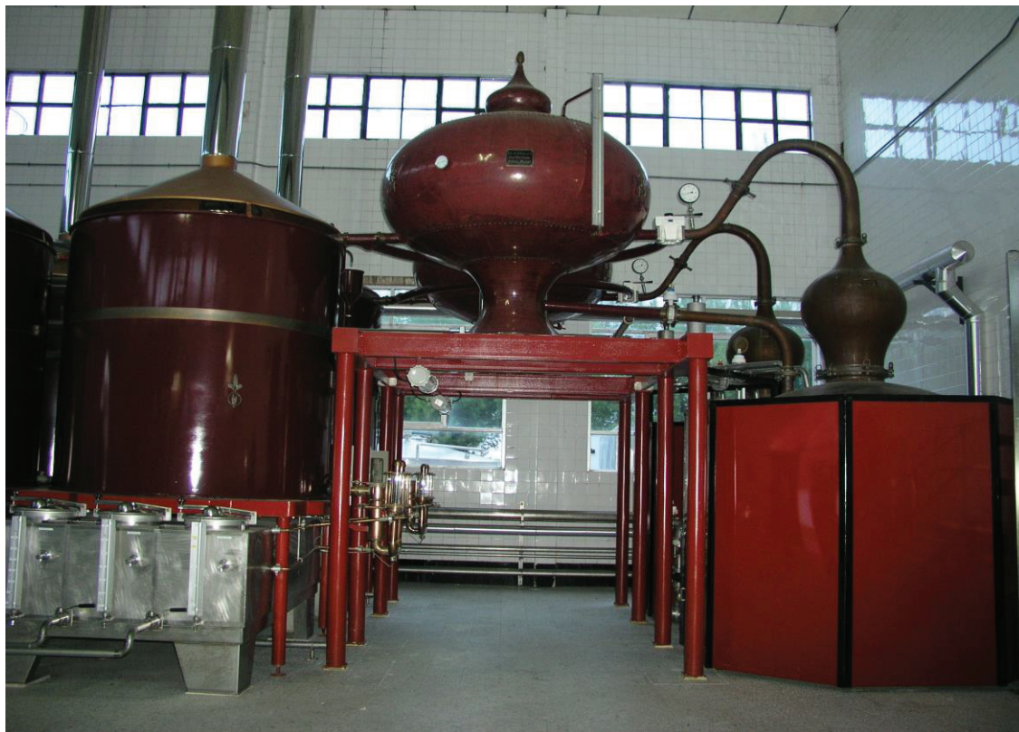
Рис. 9.1. Дистиляційна установка шарантського типу
