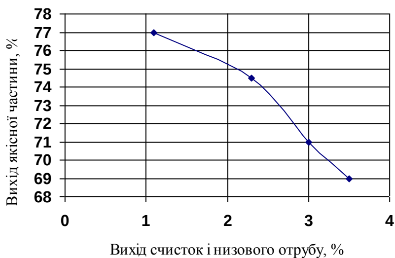
Рисунок 4 – Вихід сортового металу від кількості счисток і низового отрубу
