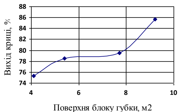
Рисунок 3 – Вихід криці в залежності від поверхні блоку губчастого титану
