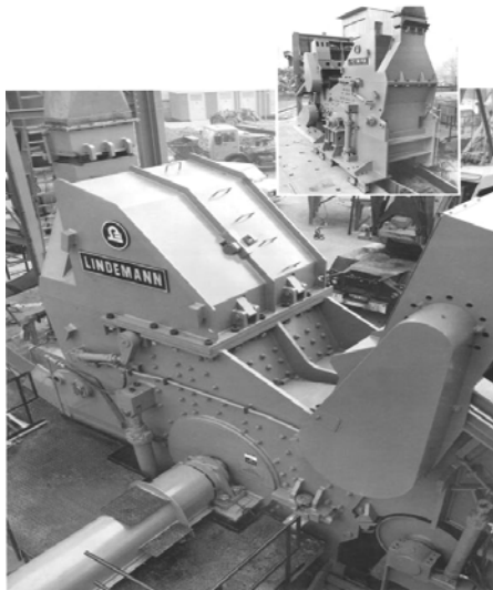
Рисунок 14.25 - Молоткова дробарка крупного дроблення фірми «Ліндерманн», Німеччина
