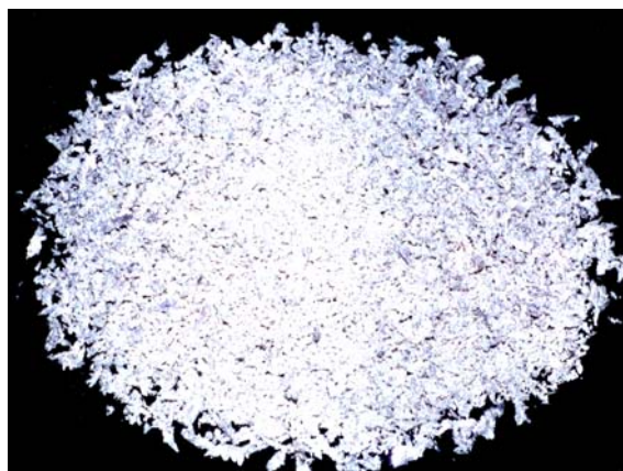
Рисунок 14.5 – Порошок катодний срібний ( \times 1 )
