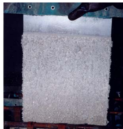
Рисунок 14.10 – Катод титановий з осадом срібла
