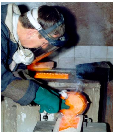
Рисунок 14.8 – Відливання анодів чорнового срібла з печі ICT-0,05
