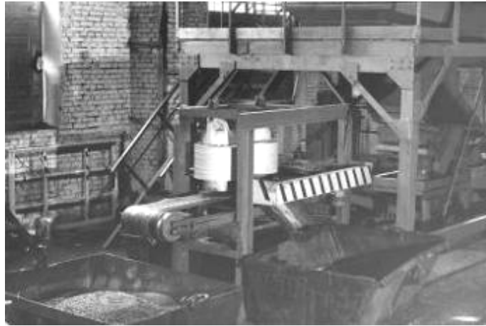
Рисунок 14.41 – Установка СЕ-4 для виділення магнітної і слабомагнітної фракцій
