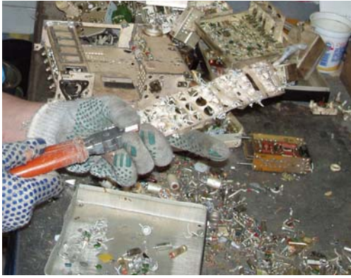
Рисунок 14.13 – Блоковий демонтаж лому
