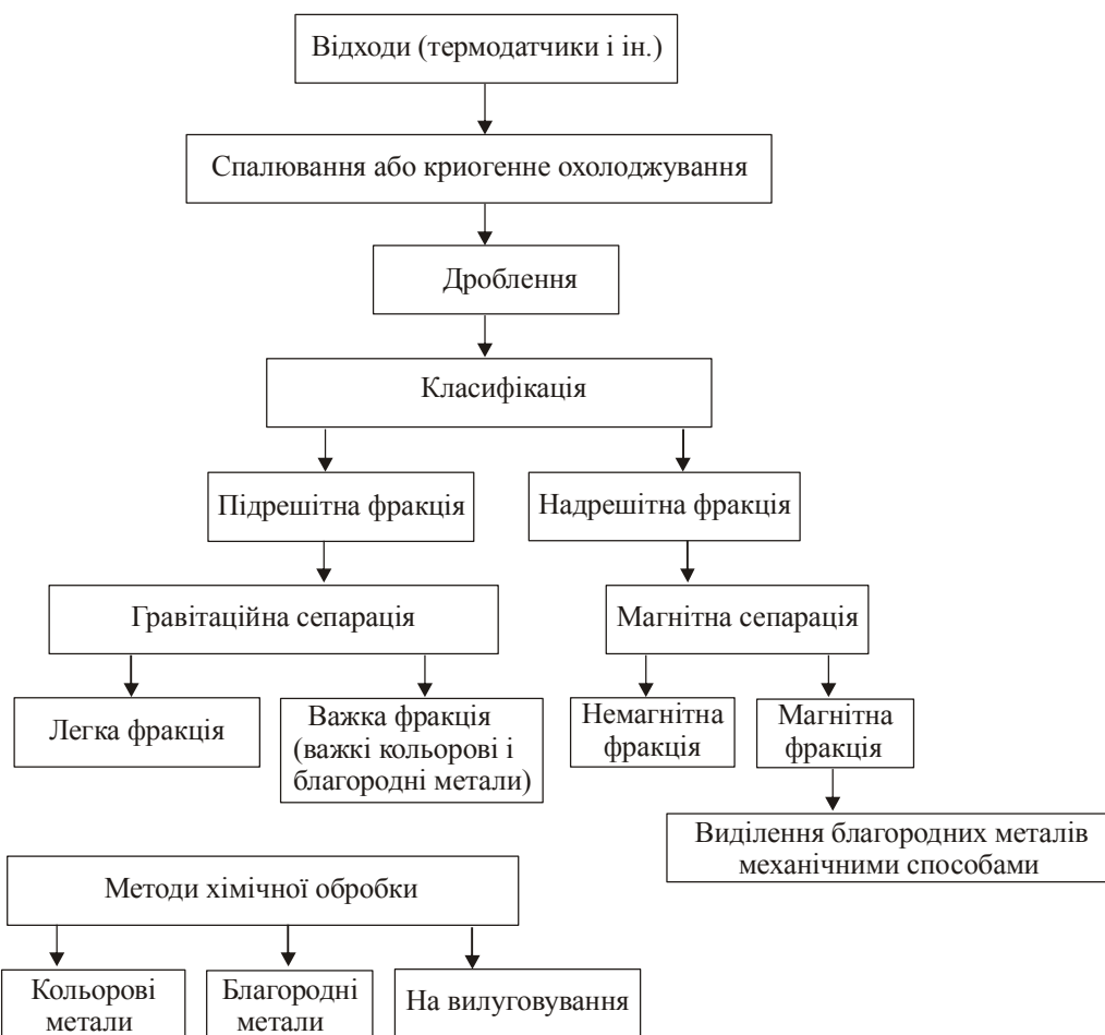
Рисунок 14.51 – Технологічна схема переробки відходів з криогенним охолодженням і хімічною обробкою
