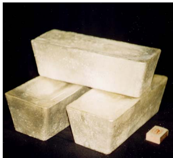
Рисунок 14.12 – Афіновані злитки Ag 99,99; маса злитка 28...32кг, ГОСТ 28595-89
