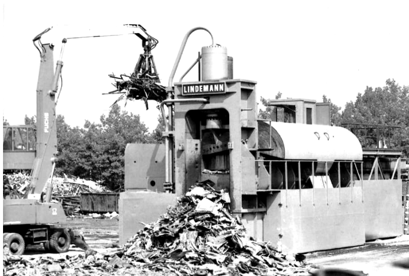
Рисунок 14.22 – Гільйотинні прес-ножиці фірми «Ліндемманн», Німеччина
