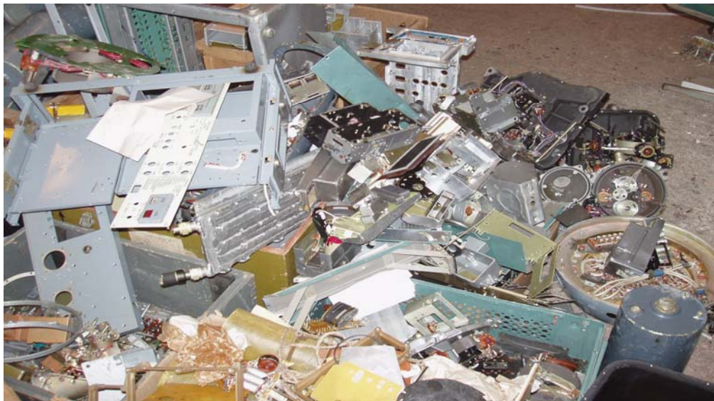
Рисунок 14.48 – Блоки, вузли і елементи лому радіо- і електротехнічних виробів
