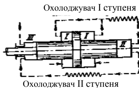
Рис. 2.9 – Триступеневий компресор з диференціальним поршнем і розділеним першим ступенем
