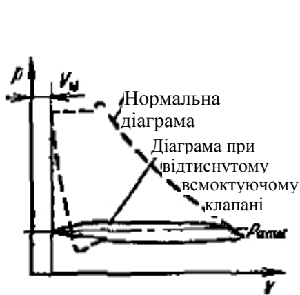
Рис. 2.19 – Індикаторна діаграма при регулюванні подачі відтисканням пластин всмоктувального клапана
