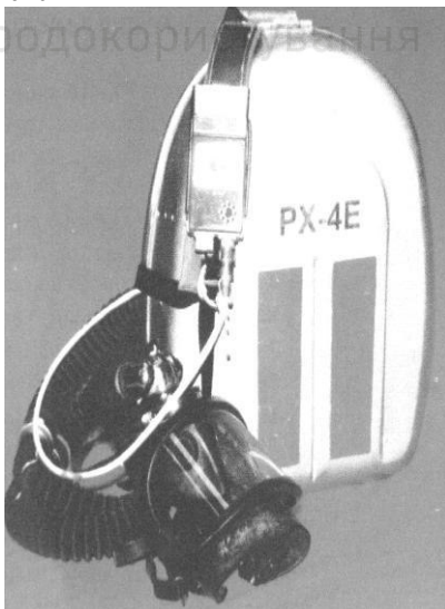
Рис.2.11. Респиратори з хімічно зв'язаним киснем: а - PX-4П, б - PX-4E
