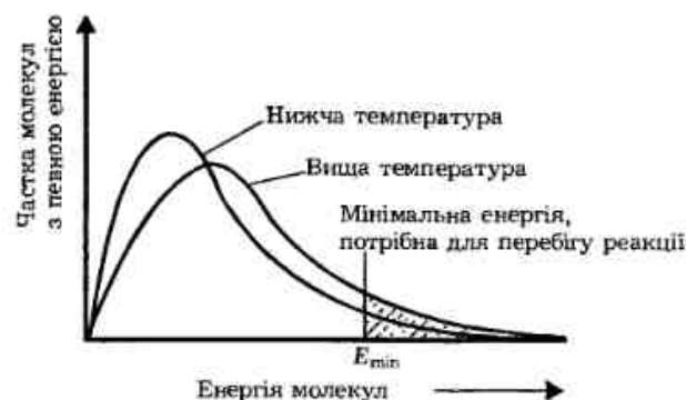
Рис. 10.2. Розподіл енергій молекул газу за двох різних температур
