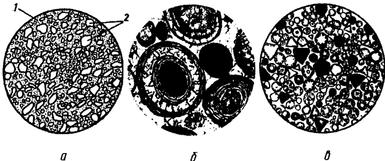
Рис. 3.2. Структури осадових гірських порід: а– піщаник (1– цементуюча речовина; 2– зерна піску); б – вапняк-ракушник; в – діатомит .
