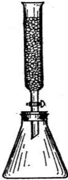
Рис. 14. Редуктор Джонса для попереднього відновлення феруму
