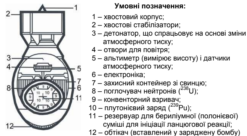
Рис. 1.8. Схема найпростішої атомної бомби (Сахаров, 2006)
