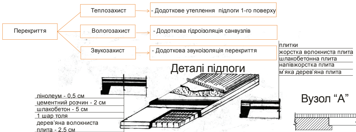
Рис.2 Методи утеплення покриттів великопанельних житлових будинків перших масових серій
